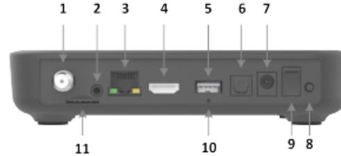
1. Antenne RF ou entrée de câble (optionnel).
